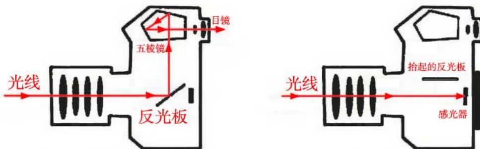
光通过镜头进入机身，在反光板上进入五棱镜，之后再通过五棱镜到目镜里，让我们取景。拍摄时，有对焦元件对焦完毕，反光板抬起，快门帘打开，光落在感光器上，被记录下来。这就是单反的原理。
