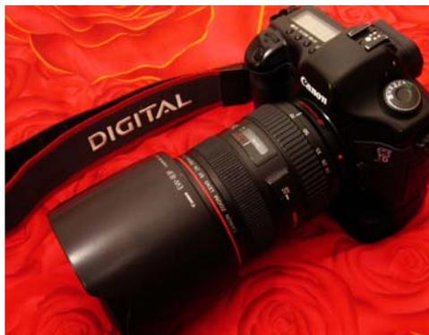
数码单反相机（DLSR）实际上就是感光器和存储介质由胶片换成了电子感光器和存储卡而已，也就是数码化的单反。
